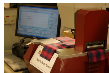
织物触感测试仪可对织物多种物理指标同时进行经纬双向的测量
